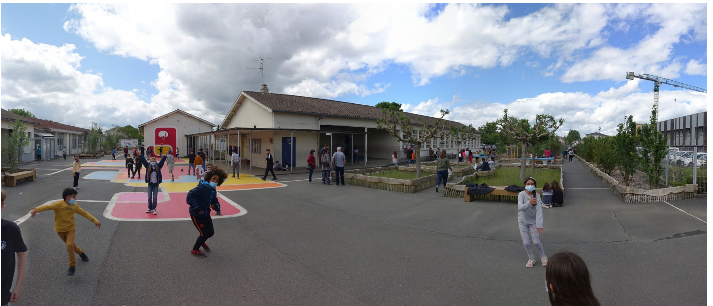
▲ Le sol coloré au centre de la cour contribue à réduire la chaleur renvoyée par le bitume
