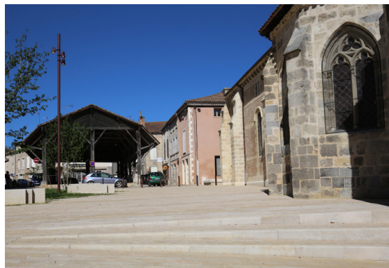
L'intervention apporte une unité à l'ensemble des espaces publics. Le patrimoine architectural du centre ancien (halle au blé et Collégiale) est valorisé par le recours à une matérialité unique pour les sols (pierre et béton de pierre calcaire) et par une gestion précise de l'altimétrie, ici l'embranchement créé sur le parvis.
